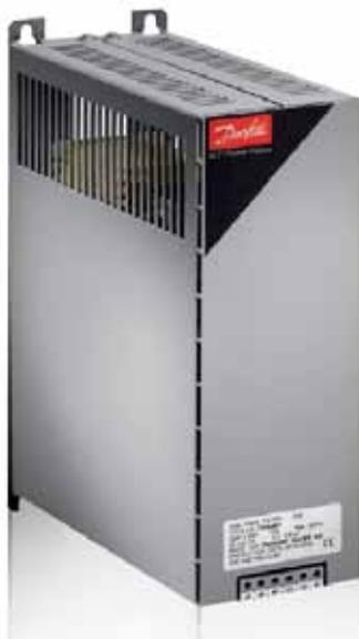
VLT® Sine-wave Filter MCC 101 sono filtri passa-basso che eliminano le componenti della frequenza di commutazione dell'inverter, "addolcendo" la tensione fase-fase in uscita dall'azionamento, rendendola sinusoidale. Ciò riduce lo stress sull'isolamento del motore e la corrente sui cuscinetti.
